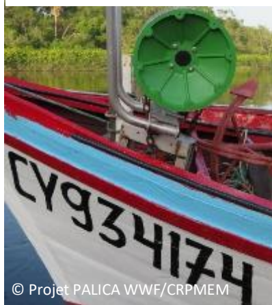
Figure 11 : Navire équipé de vire-filet au point de débarquement de Sinnamary
