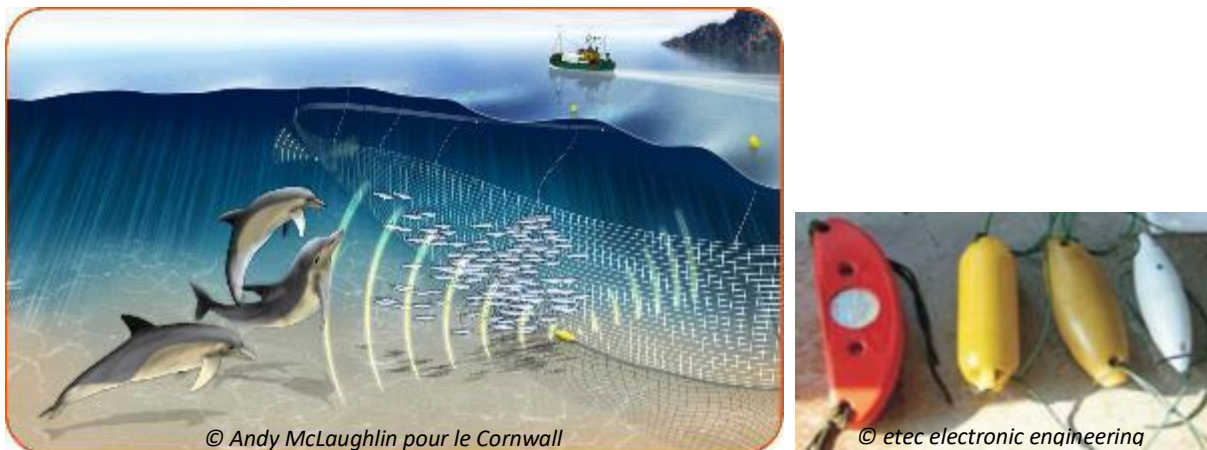
Figure 60 : Répulsifs acoustiques fixés sur les filets de pêche pour repousser les cétacés
