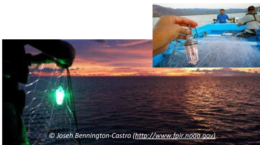
Figure 55 : LEDs fixées sur les filets maillants pour alerter les tortues marines de la présence de l'engin de pêche
