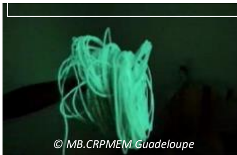
Figure 56 : Corde extrudée phosphorescente testée en Guadeloupe
